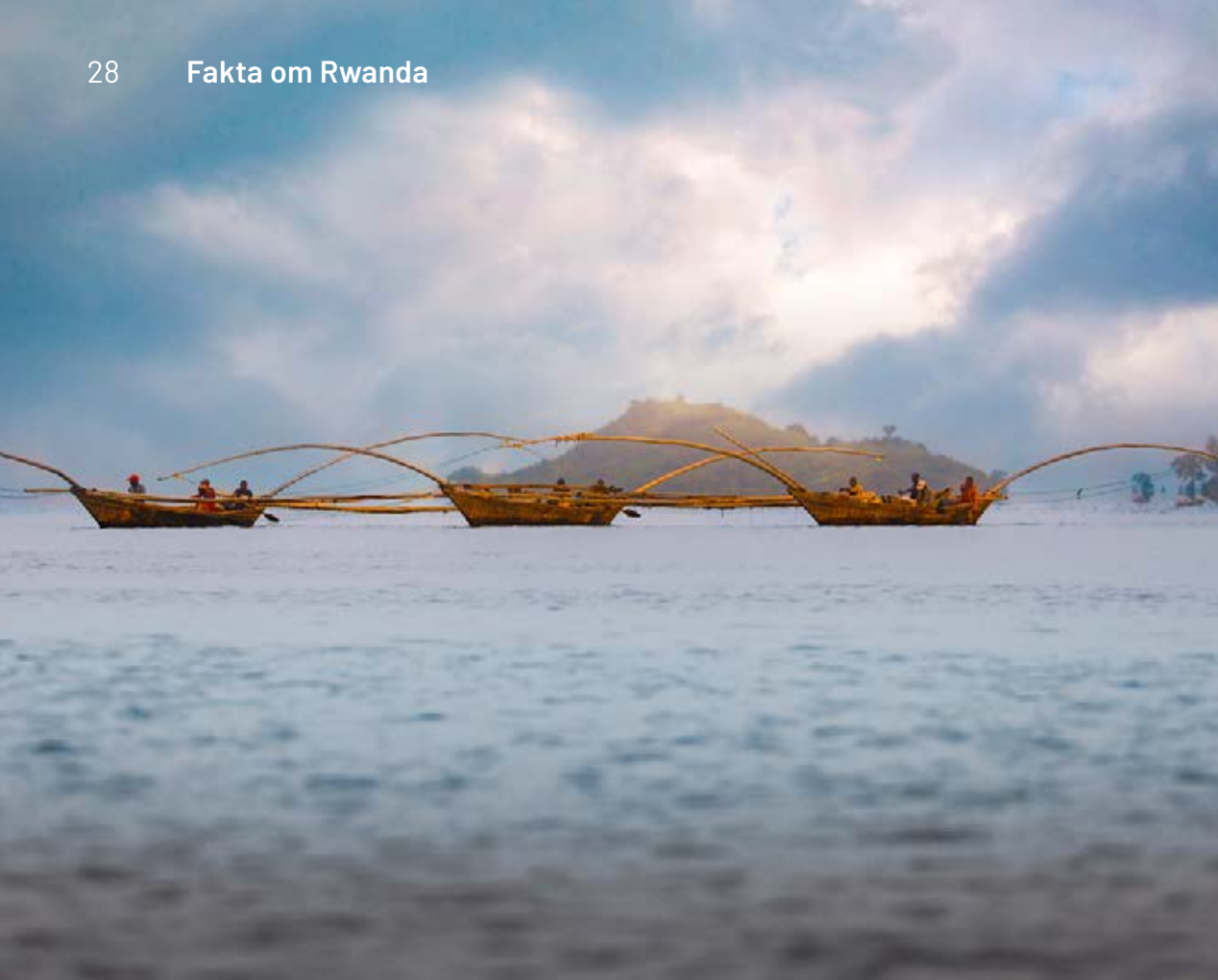
Fiskerbådene i Kivusøen har en helt særlig konstruktion. De består af tre lange trækanoeer forbundet af tynde eukalyptus-stammer. Forrest og bagest stikker master ud, som holder nettet.
